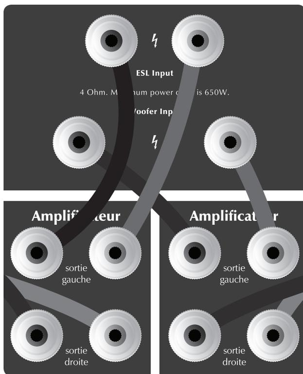
Figure 4. Raccordement par bi-amplification horizontale. Un canal illustré.
