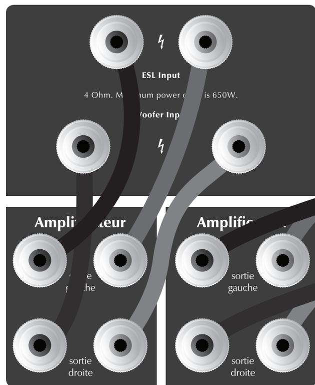
Figure 5. Raccordement par bi-amplification verticale. Un canal illustré.
