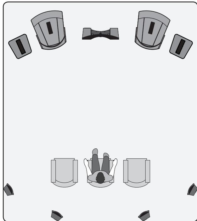
**Figure 20.** Enceintes Neolith comme canaux avant, enceintes électrostatiques MartinLogan comme canal central et ambiophonique (effets), et caissons de sous-graves MartinLogan comme canal LFE (effets).
