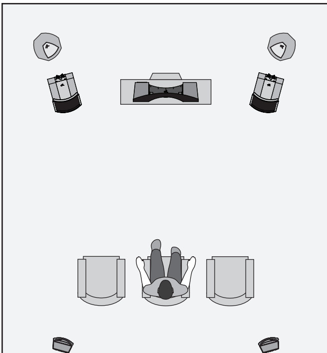
Figure 11. Enceintes Summit XJR comme canaux avant, enceintes électrostatiques MartinLogan comme canal central et ambiophonique (effets), et caissons de sous-graves MartinLogan comme canal LFE (effets).
